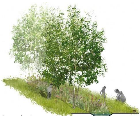
les noues champêtres : récupération et tamponnement des eaux pluviales le long des circulations
